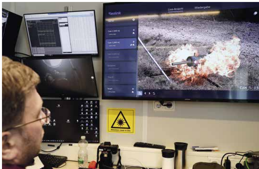
Rechts: Mit dem kleinen Laser Milos zerstört ein Bundeswehrtechniker in Meppen eine Mine
