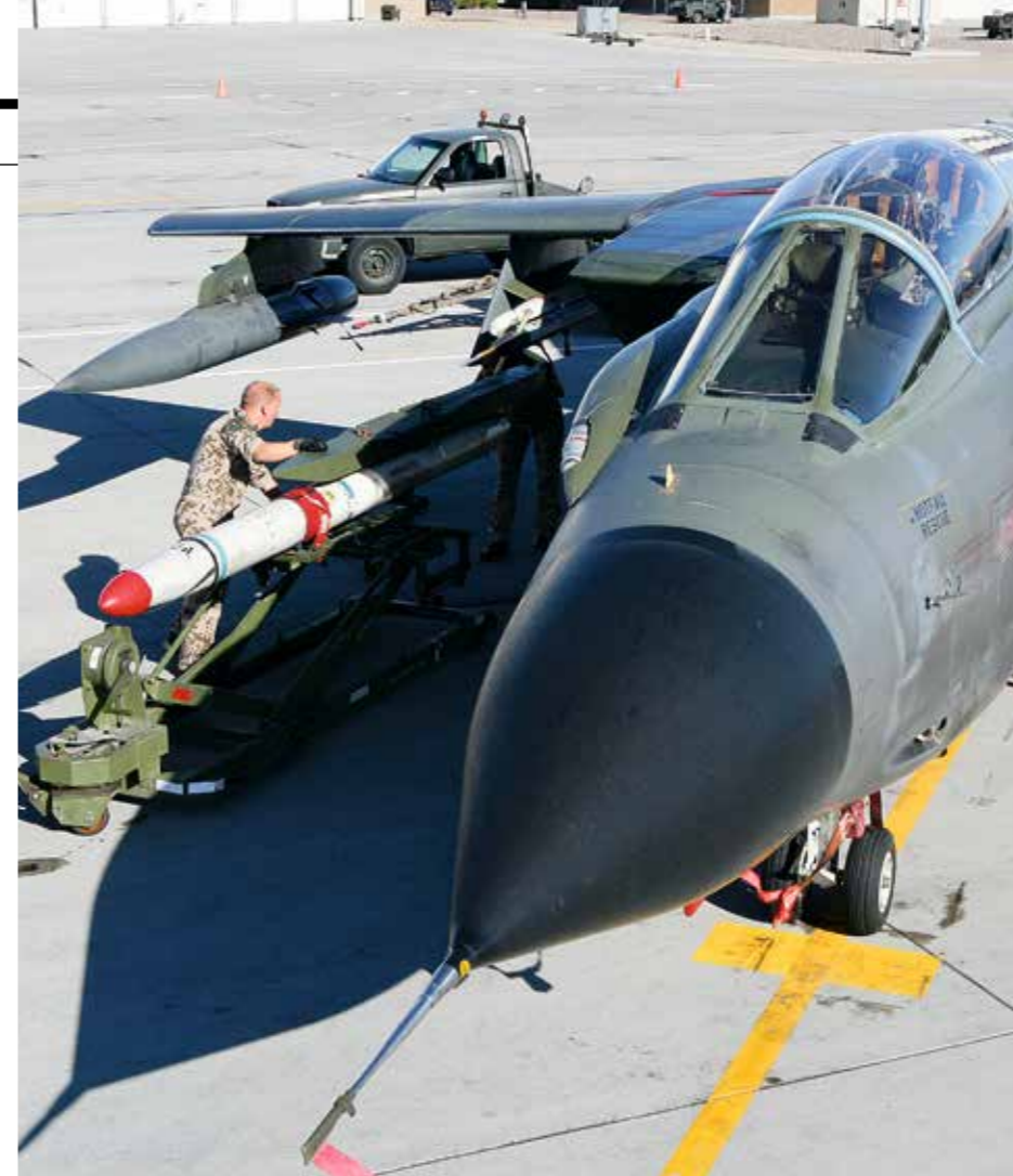
Auslaufmodell Tornado: Mechaniker montieren eine Luft-Boden-Rakete
