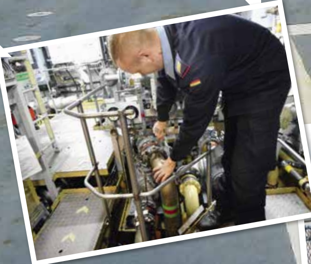
Ich bin in die Ausbildung eingebunden, hier erkläre ich einem Kameraden technische Details zur Abortvakuumanlage für die Toiletten an Bord
