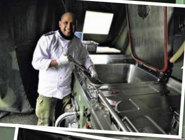
Rechts: StUffz Schwarz zündet mithilfe von Petroleum das Brennaggregat an
