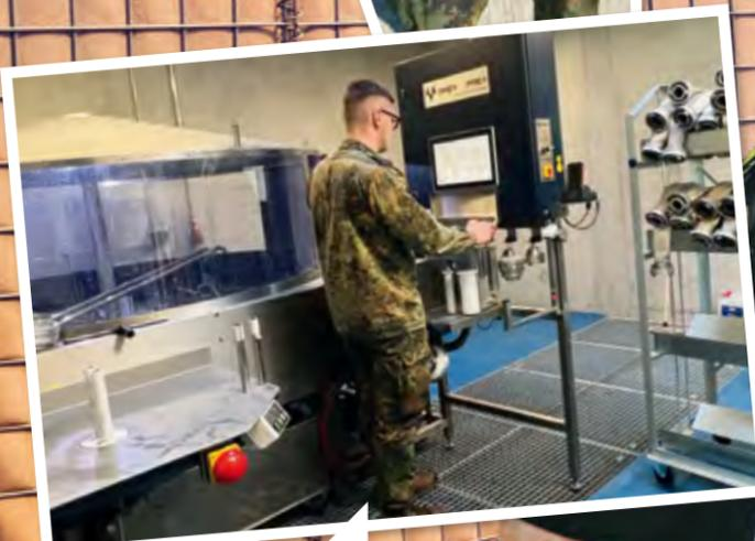
Oben: Mit dieser Anlage reinigen wir Schläuche. Rechts: Löschübung in Mali. Unten: Ich prüfe eine Liege für Leute mit einer möglichen Rückenverletzung
